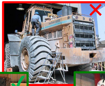
Izquierda: Inseguro - Mecánico sin protección contra caídas
