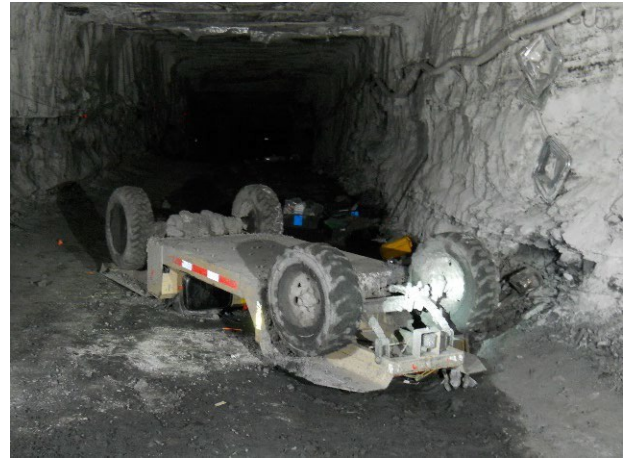
Un minero resultó mortalmente herido mientras viajaba en un vehículo de transporte de personal. La parada de emergencia se activó en una pendiente ascendente, provocando que el vehículo perdiera el control, volcara y el minero quedó atrapado debajo.
