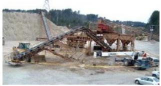
Un operador de equipo estaba preparándose para mover una polea principal a la cabeza de una sección de banda transportadora en una planta portátil. Este fue golpeado y matado al caerle encima la banda que estaba alistando para levantarla.
